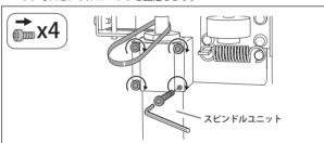
グルトをモータープーリーにかける。 図の矢印の位置を加工機本体左側に向けて押し、ベルトをモータープーリーにかけます。
