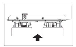
Quando as cabeças de impressão entrarem em contato com a tampa do equipamento, gire a ferramenta da unidade protetora mais uma ou duas vezes.
