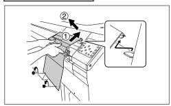
Remova os parafusos, levante a tampa R na direção ①, e então puxe-a na direção ②.
