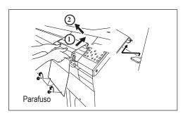
Remova os parafusos, levante a tampa R na direção ①, e então puxe-a na direção ②.
