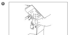
Toque no local mostrado na figura para drenar qualquer eletricidade estática.
