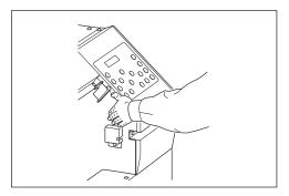
Toque no local mostrado na figura para drenar qualquer eletricidade estática.
