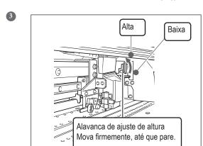
Mova a alavanca de ajuste de altura para ajustar a altura da cabeça de impressão.
