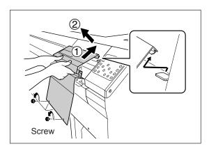
Remova os parafusos, levante a tampa R na direção ①, e então, puxe-a na direção ②.
