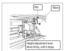
Mova a alavanca de ajuste de altura para ajustar a altura da cabeça de impressão. Mover a alavanca para "HIGH" (alto) faz com que o bipe de alarme soe duas vezes. Mover a alavanca para "LOW" (baixo) faz o bipe de alarme soar uma vez.
