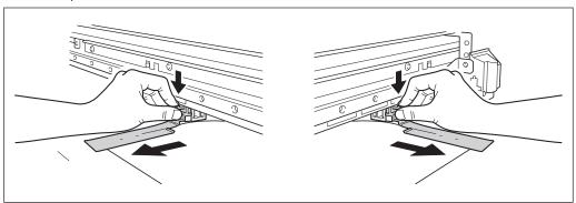
Quando for utilizar a mídia em rolo e somente cortar, deixe a mídia pendurada na traseira da máquina. (ou ajuste o menu [PREFEED] (Pré-alimentação) para "ENABLE (Habilitar)")
