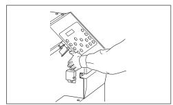
Toque no local mostrado na figura para drenar qualquer eletricidade estática.
