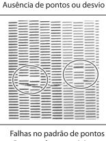
Falhas no padrão de pontos são causadas por sujeira nas cabeças de impressão.
