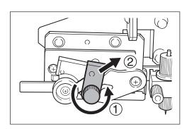
Remova a lâmina de separação.
