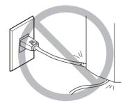
Ne jamais déposer aucun objet sur le câble, sur la fiche ou sur la prise car cela risque de les endommager.
