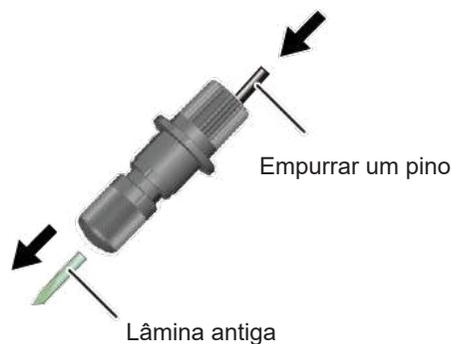
**3** Instale uma nova lâmina.
