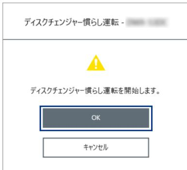
作業完了のメッセージが表示されたら、ディスクチェンジャーの慣らし運転は完了です。
