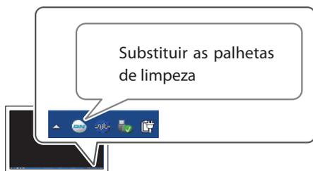
O limpador é um componente utilizado para limpeza das cabeças de impressão. Quando a mensagem mostrada na figura aparecer no ícone Utility na área de trabalho do computador, estará na hora de substituir o limpador por um novo.
