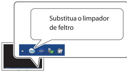
O limpador de feltro é um componente utilizado para a limpeza das cabeças de impressão. Quando a mensagem mostrada na figura aparecer no ícone Utility na área de trabalho do computador, estará na hora de substituir o limpador por um novo.
